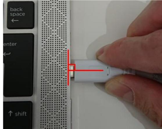
Bitte beachten Sie, dass das Kabel, Rechner oder Bildschirm beschädigt werden können, wenn die Verbindung auf folgende Weise ein- oder ausgesteckt wird.
