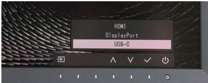
Der Monitor lässt sich dank der druckempfindlichen Tasten und des sehr übersichtlich strukturierten Menüs einfach und ohne Software bedienen. Der CS2400S ist ab Werk kalibriert und kann direkt eingesetzt werden.
