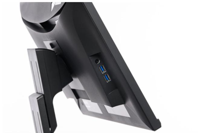
*Zwei USB-3.0-Downstream-Ports und die Kopfhörerbuchse seitlich im Erker*
