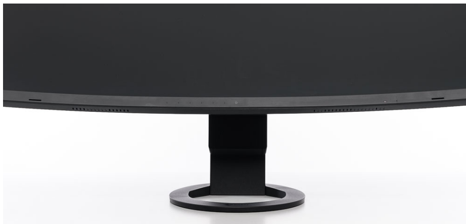
Nach vorn gerichtete Lautsprecher: Schlitze an den äußeren Rändern
